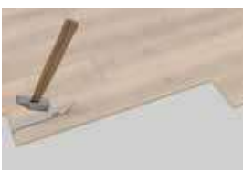
5. Hit the short of the plank until it fits together. Golpear el lado corto hasta encajar. Il faut frapper le petit côté jusqu'à ce qu'il s'enclenche en place.
